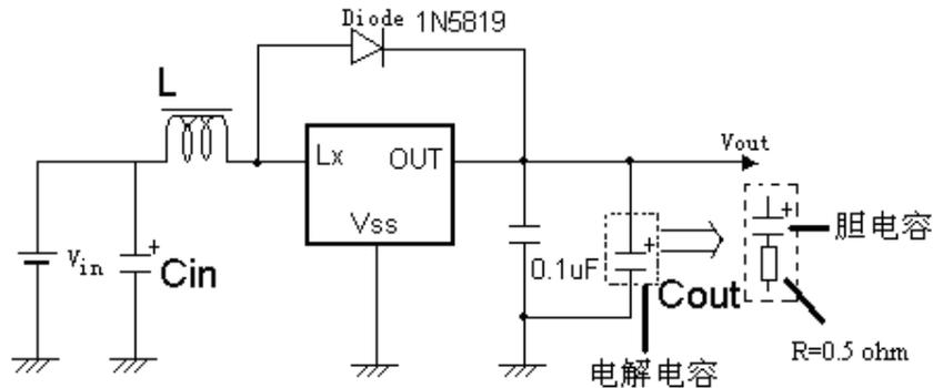
锂电池输入条件下 TP8350 驱动大负载电路
