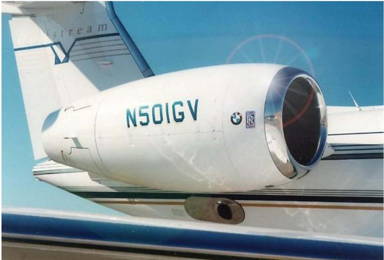
Поскольку действующий входной диаметр слегка увеличивается за счет закругления краев входного отверстия, действующий поток воздуха и разница скоростей на входе и выходе возрастают.
